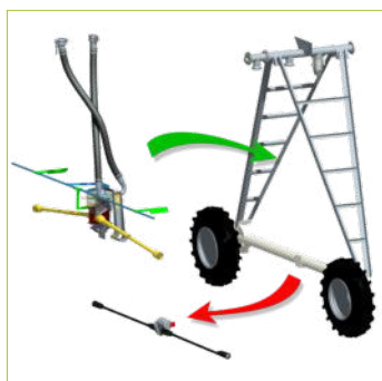
La tour motrice est une tour finale classique sur laquelle le système de propulsion est connecté (remplacement de la motorisation électrique par une turbine et sa transmission)
