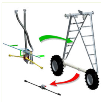
La torre motrice è una torre finale classica, sulla quale è installato il sistema motrice (i motori elettrici sono sostituiti da una turbina idraulica ed un sistema di trasmissione)
