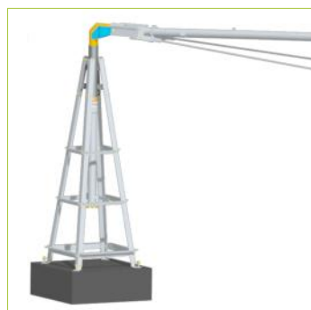
Elemento centrale semplificato rinforzato, senza quadro di comando e sistema di ancoraggio nel cemento ridotto (1.40x1.40m)
