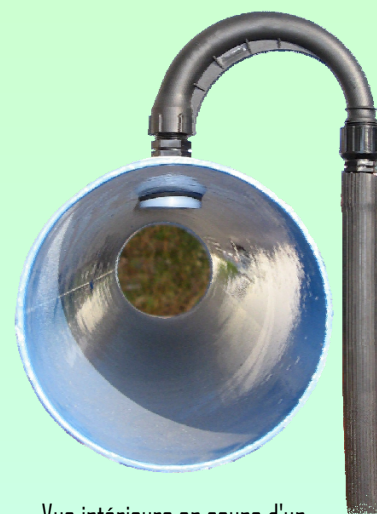
Vue intérieure en coupe d'un tube revêtu
